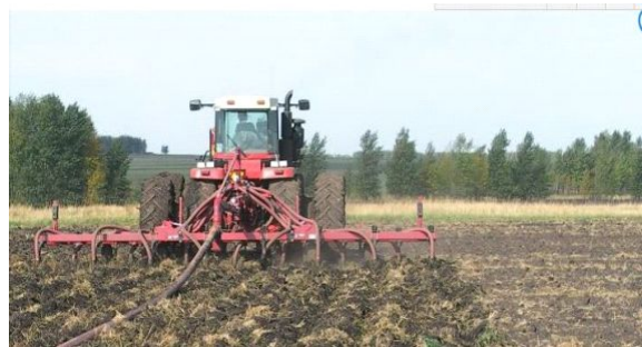
图 3 左:槽罐施肥车(适合浅土层施肥) 右:拖曳软管施肥机(适合深土层施肥)
