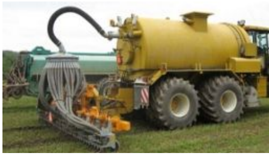
图 3 左:槽罐施肥车(适合浅土层施肥) 右:拖曳软管施肥机(适合深土层施肥)
